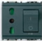
16273 Bpresa 16 A P17/11 250 V~, 1P+N C 16 - 2 moduli
