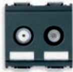
16307.01 Diretta (derivata), demiscelata, 1 dB, maschio (TV-RD) e femmina tipo F (SAT) - 2 moduli
