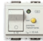
16511.10.B C 10, I \Delta n 10 mA p.i. 3000 A - 2 moduli
