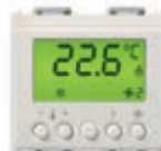
16915.B Termostato per controllo ON/OFF temperatura (classe I, contributo 1%) di 2 zone indipendenti, standard KNX, 1 uscita a relé NO 4 A 24 V~, 1 ingresso per sensore NTC 20432, 19432, 14432 o 02965.1, 1 ingresso digitale programmabile - 2 moduli
