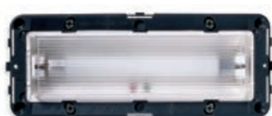
Δ 16440 D'emergenza autonomo 230 V~ 50/60 Hz, batteria al Ni-Cd ricaricabile e sostituibile, con lampada fluorescente FD 4W G5 supporto incorporato per sca- tole 6/7 moduli
