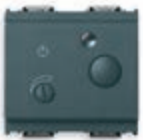
16572 Comando luce scale, locali di servizio, aspi- ratori domestici, uscita relé NO 6 A 230 V~, alim. 230 V~ 50/60 Hz - 2 moduli
