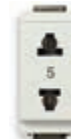
17044.B 2P 15 A, standard euro- americano polarizzato (spinotti piatti paralleli e spinotti \phi 4,8 mm)
