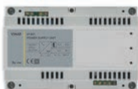
01401 Alimentatore, uscita 29 Vdc 1280 mA, 120-230 V~ 50/60 Hz, 8 moduli da 17,5 mm
