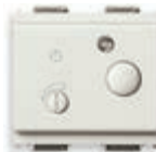
16572.B Comando luce scale, locali di servizio, aspi- ratori domestici, uscita relé NO 6 A 230 V~, alim. 230 V~ 50/60 Hz - 2 moduli
