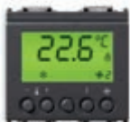
16915 Termostato per controllo ON/OFF temperatura (classe I, contributo 1%) di 2 zone indipendenti, standard KNX, 1 uscita a relé NO 4 A 24 V~, 1 ingresso per sensore NTC 20432, 19432, 14432 o 02965.1, 1 ingresso digitale programmabile - 2 moduli
